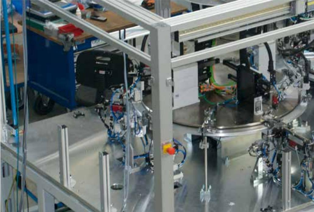
**Montageautomat für elektromechanische Sensoren: 3 Rundschalttische und 11 direkt angetriebene Pick & Place-Einheiten stammen von WEISS. Aus einer Hand und optimal aufeinander abgestimmt. Die Kombination erreicht eine Positioniergenauigkeit von 0,02 Millimeter.**
